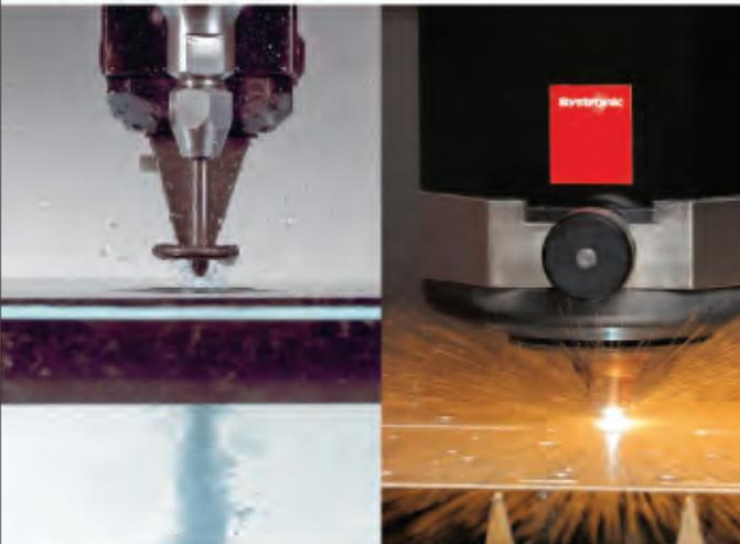
**Wasserstrahl- und Laserschneiden.**
